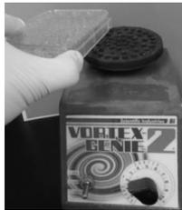
図3 ボルテックスによるウェルプレートの振盪
